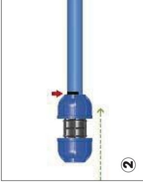
Inserimento del raccordo fino al segno Insertion of the fitting until the mark
